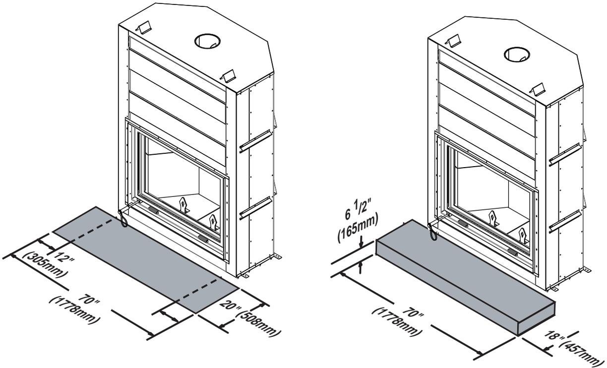
La base de protection doit se prolonger de 20" (508mm) à l'avant de la façade lorsqu'elle n'est pas surélevée (voir les codes du bâtiment locaux). La base de protection doit se prolonger d'un minimum de 12" (305mm) de chaque côté de l'appareil [70" (1778mm)].
