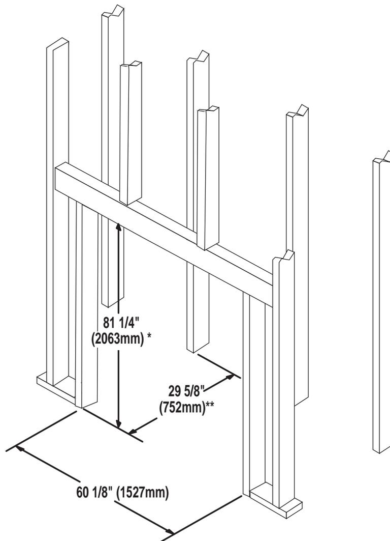
\* Prévoyez l'épaisseur du plancher fini et de la base de protection lorsque vous déterminez ces dimensions.
