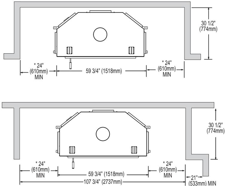
**\* Il est recommandé de laisser un minimum de 24" (610mm) de dégagement sur les côtés de l'appareil pour faciliter l'entretien de soit la porte guillotine ou du système d'exploitation de l'écran, l'accès à cet espace devra être pris en considération.**
