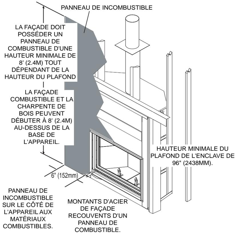
**AVERTISSEMENT:** Les vis utilisées pour fixer les matériaux de finition à la face de l'appareil au-dessus de l'écran de la guillotine et la porte ne doivent pas dépasser 1/2" (13 mm) de longueur. Se référer à la section "DIMENSIONS" pour les besoins spécifiques.
