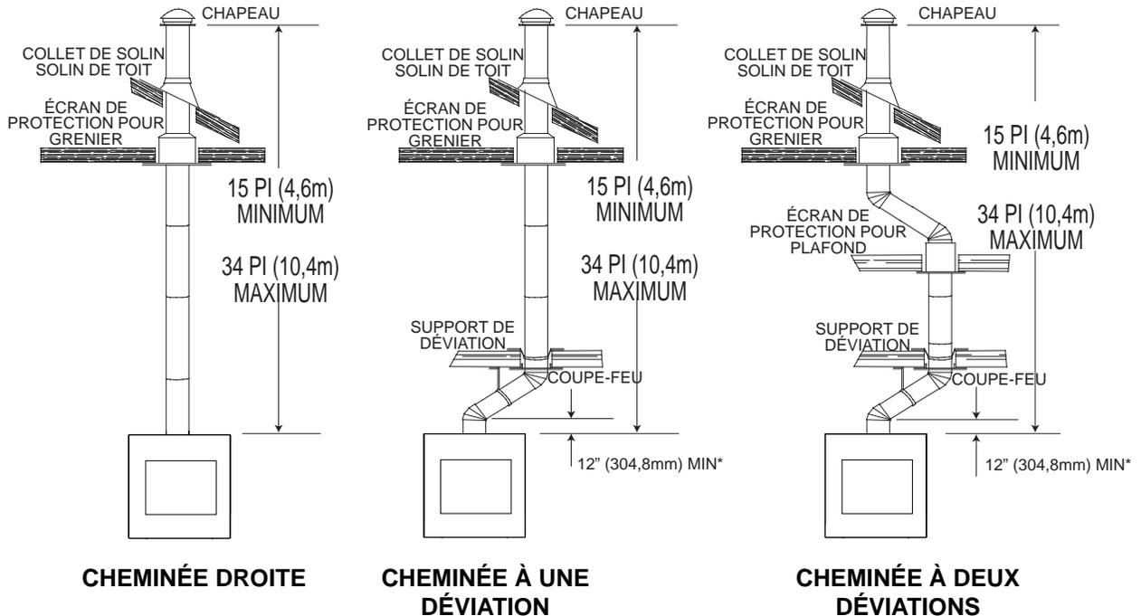
\* La première déviation du conduit doit être à une distance minimale de 12" (304,8mm) du dessus de l'appareil.
