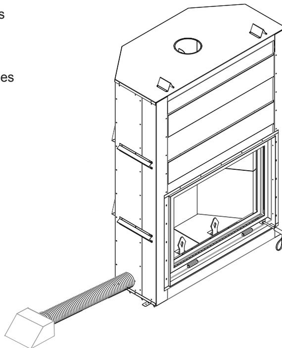
L'entrée du conduit doit être placée de sorte qu'elle ne peut pas être bloquée (c.-congères). 12" (305mm) du sol est recommandé. Faites un trou de 4½" (114mm) pour répondre dans un mur extérieur de la maison. De l'extérieur, placez le capot de l'air frais dans le trou, côté ouvert vers le bas. Sceller avec du calfeutrage et sécurisé.
