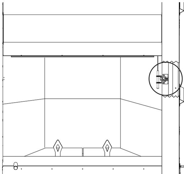
Pour fermer le registre, tirez la tige de commande de l'amortisseur vers le bas et poussez-le vers la droite. Pour ouvrir le registre, pousser la tige de commande de l'amortisseur sur le côté gauche et la libéré.
