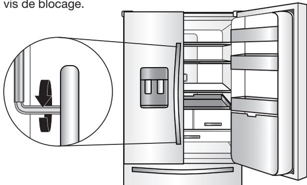
5. Serrer la vis de blocage jusqu'à ce qu'elle commence à toucher la vis à épaulement en la tournant dans le sens horaire. Ne pas serrer complètement.
