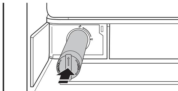
7. Faire tourner le filtre de 90 ° dans le sens horaire jusqu'à ce qu'il soit verrouillé en place et que les flèches soient alignées.
