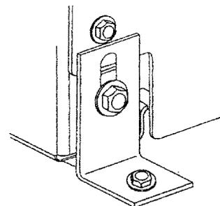
5. Régler le support antibasculement de façon qu'il repose en toute sécurité sur le plancher. **SERRER MAINTENANT COMPLÈTEMENT LA VIS.**
