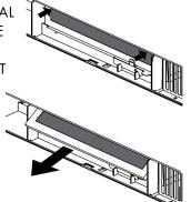
4. SLIDE THE TOP OF THE NEW CHARCOAL FILTER INTO THE TOP OF THE FILTER CAVITY.
