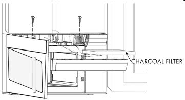
3. REMOVE THE CHARCOAL FILTER BY PUSHING THE TOP OF THE FILTER INWARDS, THEN PULL IT FORWARD OUT FROM THE UNIT.
