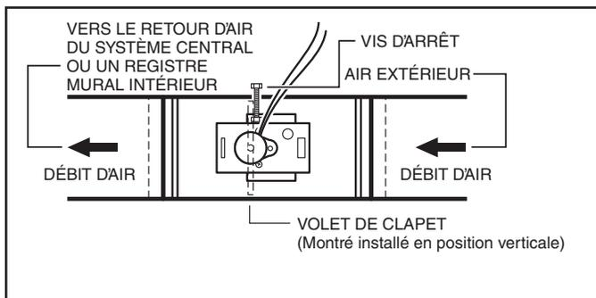
Installez le clapet tel qu'illustré. Assurez-vous que le volet du clapet est en position verticale lorsqu'il est fermé et que le courant est coupé. L'ouverture du clapet peut être réglée à l'aide de la vis d'arrêt - en équilibrant la pression d'air intérieur et extérieur lorsque la hotte de cuisine expulse l'air à haute vitesse.
