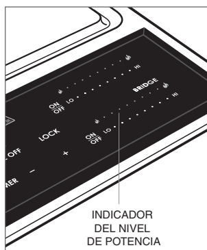
Indicador del nivel de potencia.
