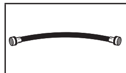
Tuyau d'alimentation court
