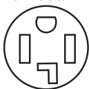
Tomacorriente de 4 hilos (14-30R)
