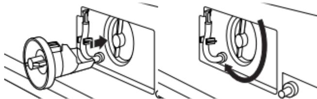
6. Replacer et fermer le tiroir distributeur. S'assurer d'insérer les deux rails simultanément lors du remplacement du tiroir. Un déclic se fait entendre indiquant que les rails sont engagés. Pour assurer un positionnement correct du tiroir, le retirer complètement. Le tiroir doit être complètement engagé et les rails verrouillés en place. S'assurer que le tuyau de vidange est bien fixé dans l'attache de tuyau et rentré sous la découpe.
