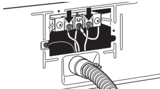
Placer les extrémités en crochet des conducteurs restants du câble pour raccordement direct sous les vis les plus à l'extérieur du bornier (crochets vers la droite). Rapprocher les extrémités du crochet et serrer la vis. Placer la languette du couvercle du bornier dans la fente du panneau arrière de la sècheuse. Fixer le couvercle avec la vie de retenue. Ensuite, aller à la section « Exigences concernant l'évacuation ».
