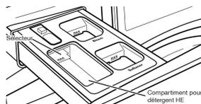
Ne pas remplir excessivement; ajouter trop de détergent peut entraîner sa distribution prématurée dans la laveuse.
