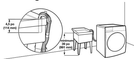
Capacité minimale : 20 gallons (76 L). Le haut de l'évier de buanderie doit être à au moins 39 po (991 mm) du sol, mais pas à plus de 96 po (2,4 m) du bas de la laveuse.
