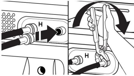
**IMPORTANT :** Pour réduire le risque de défaillance des tuyaux, remplacer les tuyaux tous les 5 ans. Inscrire la date d'installation ou de remplacement des tuyaux pour référence ultérieure.
