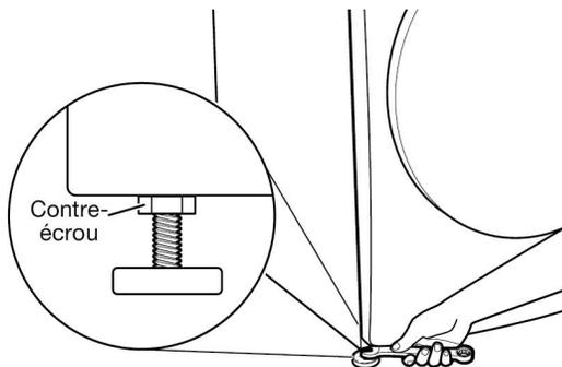
Après que l'aplomb de la laveuse a été établi et que les quatre pieds sont en contact ferme avec le sol, tourner les contre-écrous dans le sens antihoraire sur les pieds de nivellement à l'aide d'une clé à fourche ou d'une clé à molette de 9/16 po (14,3 mm) jusqu'à ce qu'ils soient bien serrés contre la caisse de la laveuse.
