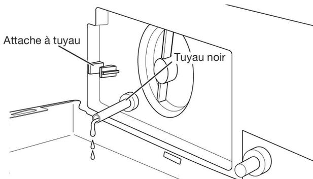
3. Placer un chiffon en coton sous le filtre de la pompe de vidange pour absorber l'eau restante. Retirer ensuite le filtre de la pompe de vidange en le tournant en sens antihoraire.
