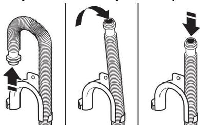
Pour les installations avec vidange au plancher, il faut retirer la bride de retenue pour tuyau de vidange de l'extrémité du tuyau de vidange. Des pièces supplémentaires avec des directives distinctes seront peut-être nécessaires; consulter le Guide de démarrage rapide.
