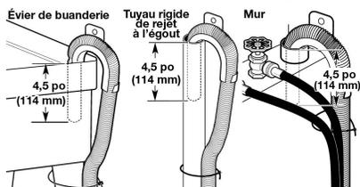
Fixer le tuyau de vidange avec le serre-câbles ou la fixation perlée au pied de l'évier de buanderie, au tuyau rigide de rejet à l'égout ou aux tuyaux d'arrivée d'eau pour le tuyau de rejet à l'égout mural rigide.
