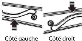
2. Placer un récipient plat sous le filtre de la pompe de vidange pour ramasser l'eau de vidange. Dégager le tuyau noir du collier de serrage, retirer le bouchon et vidanger le tuyau dans le récipient. Vider le contenant. Répéter au besoin la procédure jusqu'à ce qu'il n'y ait plus d'eau. S'assurer que le tuyau noir est complètement sec, remplacer le bouchon et fixer le tuyau dans l'attache.
