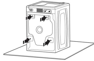
Repérer les quatre boulons de transport à l'arrière de la laveuse.
