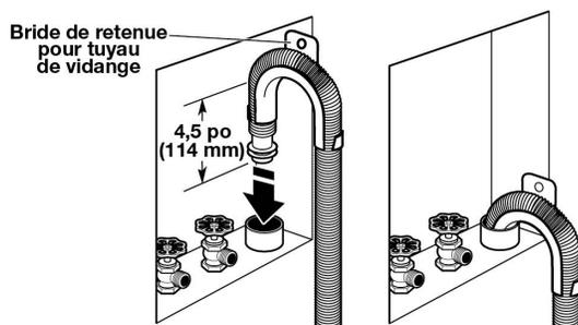
Placer le tuyau dans le tuyau de rejet à l'égout (illustré à l'image) ou par-dessus le côté de l'évier de buanderie.
