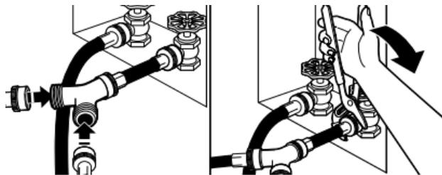
Fixer l'une des extrémités du tuyau d'alimentation de 5 pi (1,5 m) au connecteur en « Y ». Fixer le tuyau d'alimentation en eau froide de la laveuse à l'autre extrémité du raccord en « Y ». Visser le raccord à la main jusqu'à ce qu'il repose sur le raccord. Terminer le serrage des raccords de deux tiers de tour supplémentaire avec une pince.
