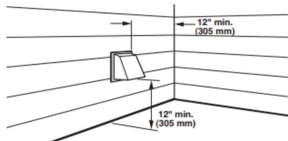
Installer le clapet d'évacuation et utiliser un composé de calfeutrage pour calfeutrer le côté extérieur de l'ouverture murale autour du clapet d'évacuation.
