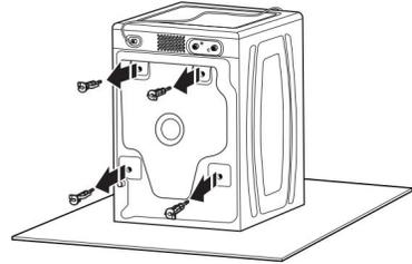
Desserrer les boulons avec une clé à molette de 5/8 po (16 mm). Glisser chaque boulon et cale au centre de trou. Retirer les boulons et cales d'espacement en plastique de l'arrière de la laveuse. Jeter les boulons et cales d'espacement.
