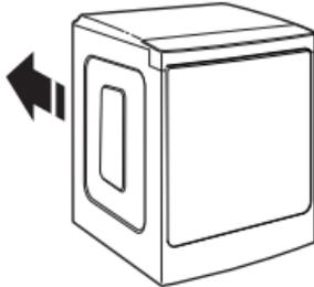
Placer la sécheuse à son emplacement final. Éviter d'écraser ou de déformer le conduit d'évacuation. Une fois la sécheuse en place, retirer les cornières et le carton sous la sécheuse.
