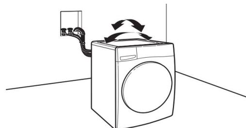
Saisir la laveuse par le dessus et la faire basculer d'avant en arrière tout en s'assurant que les quatre pieds sont en contact ferme avec le sol. Faire de nouveau basculer la laveuse, transversalement. Si la laveuse bascule, passer à l'étape 15 et ajuster les pieds de nivellement. Si les quatre pieds sont en contact ferme avec le sol, passer à l'étape 16.
