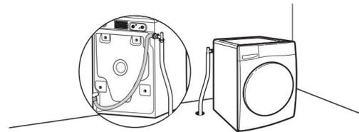
Le système de vidange au sol requiert un ensemble de brise-siphon, deux ensembles de raccordement et une rallonge de tuyau de vidange qui peuvent être achetés séparément; consulter le guide de démarrage rapide pour les renseignements de commande en ligne. Hauteur minimale du brise-siphon : 28 po (710 mm) à partir du fond de la laveuse. (Des tuyaux supplémentaires peuvent être requis.)
