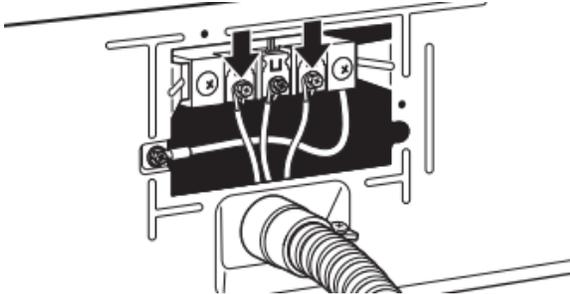
Placer les extrémités en crochet des conducteurs restants du câble pour raccordement direct sous les vis les plus à l'extérieur du bornier (crochets vers la droite). Rapprocher les extrémités du crochet et serrer les vis. Placer la languette du couvercle du bornier dans la fente du panneau arrière de la sècheuse. Fixer le couvercle avec la vie de retenue. Ensuite, aller à la section « Exigences concernant l'évacuation ».
