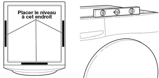
Enlever le morceau de carton placé sous la laveuse. Placer un niveau sur les bords supérieurs de la laveuse en contrôlant chaque côté et l'avant. Si elle n'est pas d'aplomb, faire basculer la laveuse et régler les pieds vers le haut ou vers le bas comme indiqué dans les étapes 15 et 16, et recommencer si nécessaire.
