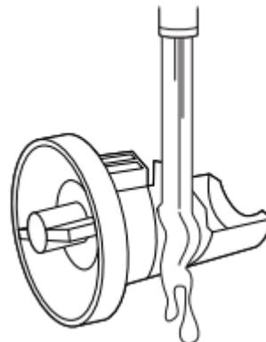
5. Replacer le filtre de la pompe de vidange en le tournant en sens horaire. S'assurer de tourner aussi loin que possible en gardant la poignée du filtre en position verticale.
