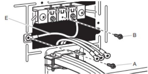
Installer le bon serre-câbles pour votre raccordement électrique. Retirer la vis de la borne centrale (B). Retirer le conducteur neutre (E) de la vis du conducteur de terre externe verte (A).
