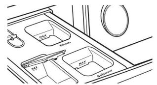
**REMARQUE :** Ne pas placer de sachets de lessive à dose unique, d'activateurs de lessive de type Oxi, d'agent de blanchiment sans danger pour les couleurs ou d'assouplissant pour tissu sous forme de cristaux dans les distributeurs. Ces produits ne se dissoudront pas correctement. Le tiroir distributeur optimal ne peut pas être désactivé.
