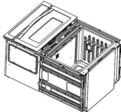
2. Installer un pied arrière (pièce numéro W10318219) sur la cale d'espacement arrière gauche avec une vis n° 8-18 x 1/2".
