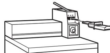
Pour une sècheuse dotée d'un mécanisme d'insertion à glissière, utiliser l'ensemble d'adaptation fourni avec la sècheuse.
