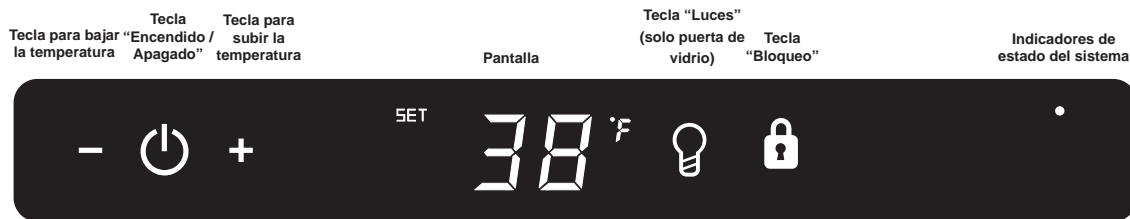
Figura 10 Control electrónico para una sola zona
