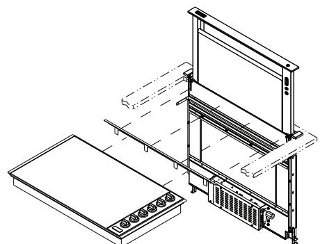
3. Cuando estén correctamente alineadas, presione la cinta y la moldura de la estufa contra el frente de la caja de ventilación. Aplique una presión moderada a cada lengüeta.
