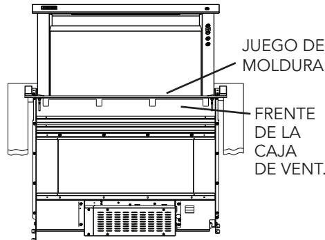
1. Coloque temporalmente la moldura de la estufa frente a la caja de ventilación del tiro descendente para alinearla con la estufa o superficie para cocinar.
