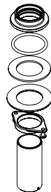
Tubería de montaje para la regadera de mano (1X en TBMV2 únicamente)
