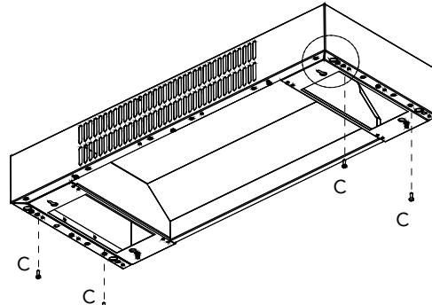
2. Instalar el deflector en la parte superior de la campana para que los tornillos C entren respectivamente en las ranuras laterales en la parte superior de la campana y en las ranuras laterales en la parte inferior del deflector, deslice el deflector hacia adelante hasta que se detenga.
