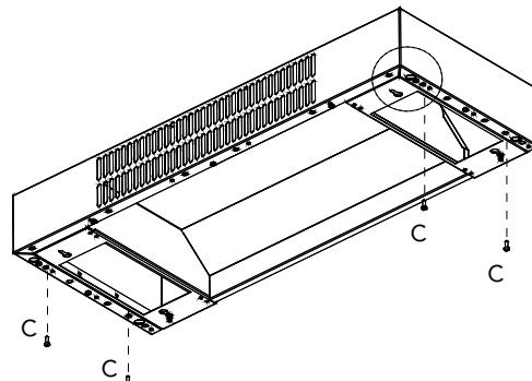
2. Installez le deflecteur sur le dessus de la hotte de tellesorte que les visses C inserent dans les cavites laterales se trouvant sur le dessus de la hotte ainsi que dans les cavites laterales sur le dessous du deflecteur, faites glisser le deflecteur jusqu'a ce qu'il se bloque.
