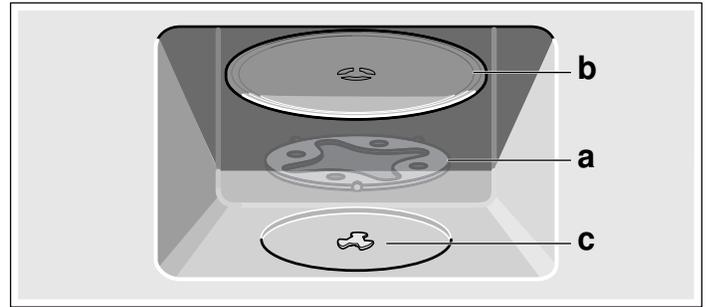
**Remarque :** N'utilisez pas l'appareil si la plaque tournante n'est pas en place. Assurez-vous que la plaque est bien en place et qu'elle peut tourner sans entrave lorsque le micro-ondes est utilisé.
