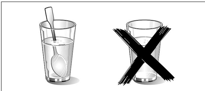
Des liquides, comme de l'eau, du café ou du thé peuvent surchauffer. Ils peuvent être chauffés au-delà du point d'ébullition sans que cela ne paraisse. Par exemple, le bouillonnement ou l'ébullition lorsque le contenant est retiré du micro-ondes n'est pas toujours présent. CELA POURRAIT RÉSULTER DANS DES LIQUIDES TRÈS CHAUDS QUI BOUILLONNERONT SOUDAINEMENT DÈS LORS QUE LE CONTENANT EST DÉRANGÉ OU QU'UN USTENSILE EST INSÉRÉ DANS LE LIQUIDE.
