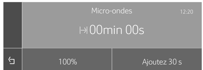
4. Effleurez le champ niveau de puissance et glissez vers la gauche ou la droite pour sélectionner un niveau de puissance différent.
