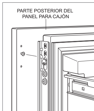
Montaje del panel del cajón
