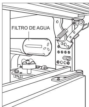
Extracción del filtro de agua.
