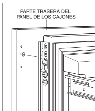
Montaje del panel del cajón.
