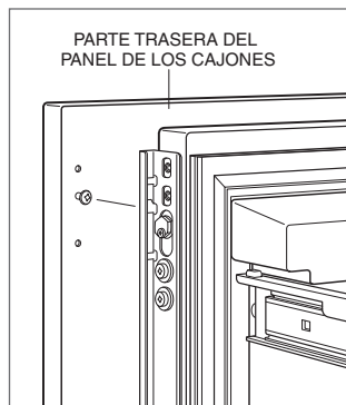
Montaje del panel del cajón.
