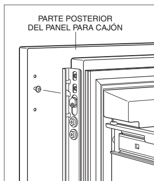
Montaje del panel del cajón.
