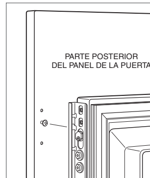
Montaje del panel de la puerta.
