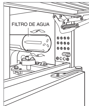
Extracción del filtro de agua
