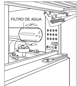
Extracción del filtro de agua.
