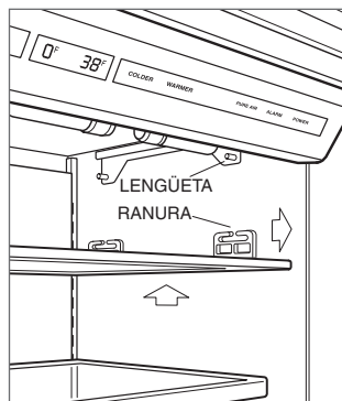
Instalación del difusor de luz.
