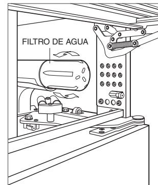
Extracción del filtro de agua.
