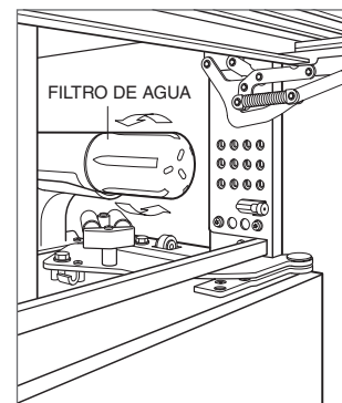
Extracción del filtro de agua.
