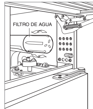
Extracción del filtro de agua.
