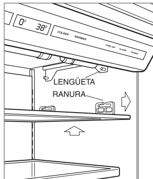
Instalación del difusor de luz.
