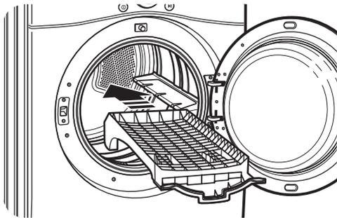
2. Assurez-vous que la grille est appuyée uniformément sur le bord de la jante interne de la porte et repose à plat à l'intérieur de la sècheuse.
