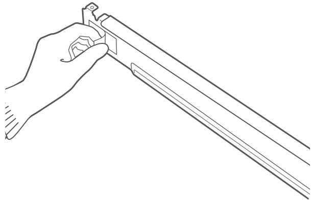
2. Adaptez le rail latéral sur le côté de la partie supérieure de la machine à laver tel qu'illustré dans la figure ci-dessous. Appuyez fermement la zone adhésive du rail sur la surface de la machine à laver. Fixez le rail latéral de la machine à laver avec une vis à l'arrière du rail. Répétez les étapes 1 et 2 pour attacher le rail de l'autre côté.
