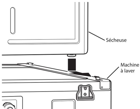
4. Insérez le rail avant entre le bas de la sècheuse et le haut de la machine à laver. Poussez le rail avant vers l'arrière de la machine à laver jusqu'à ce qu'il entre en contact avec les butées du rail latéral. Installez les deux vis restantes pour solidement fixer le rail avant aux rails latéraux.
