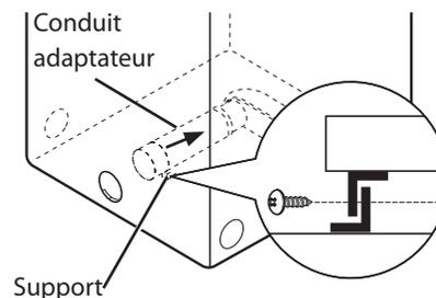
3. Insérez le coude de 4 po (10,2 cm) de diamètre dans l'ouverture arrière et enfoncez-le dans le conduit adaptateur. Assurez-vous que l'extrémité mâle du coude soit face au bas par le trou au fond de la sècheuse. Fixez solidement en position avec du ruban à conduit. Fixez la plaque protectrice au dos de la sècheuse avec la vis fournie.
