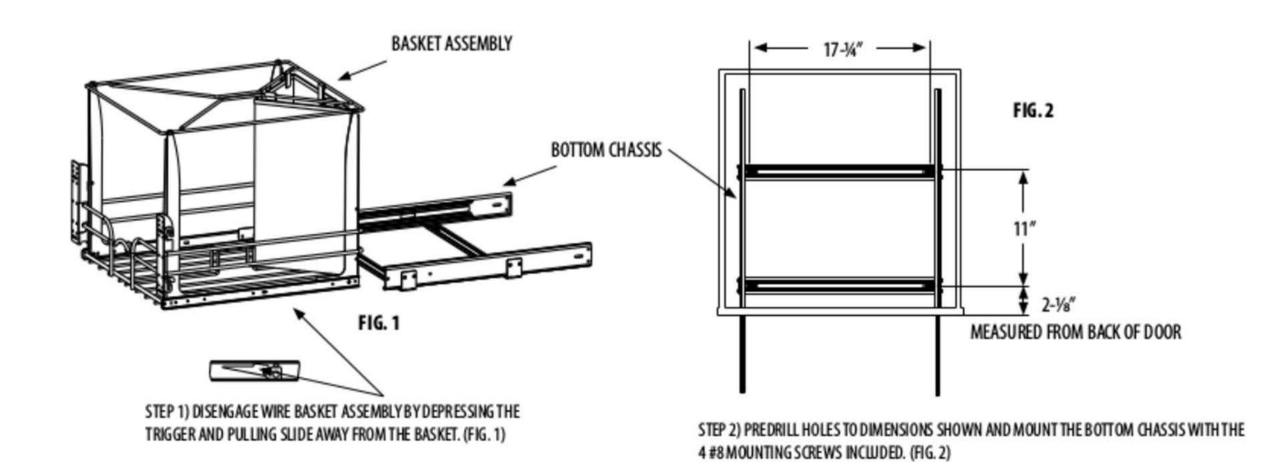
STEP 3) REINSTALL BASKET ASSEMBLY "REVERSE STEP ONE"
