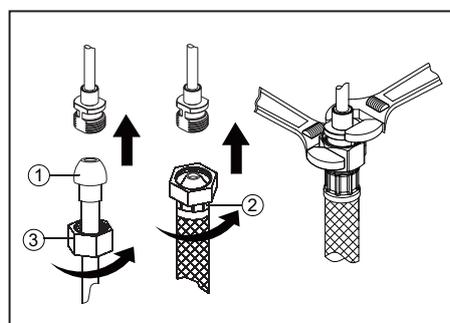
2. Branchez l'alimentation en eau. Utilisez un raccord de robinet I.P.S (2) de 1,27 cm (1/2 po) ou utilisez des écrous d'accouplement (3) pour conduite d'alimentation avec colonne montante à embout arrondi au diamètre extérieur de 0,95 cm (3/8 po) (1). Utilisez la clé pour serrer les raccords. Ne serrez pas trop.
