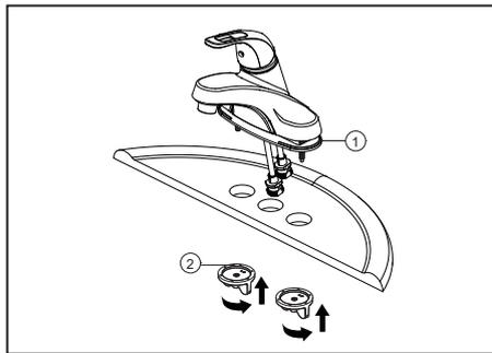
1. Couper l'alimentation d'eau principale avant l'installation. Interrompez l'arrivée d'eau. Enlevez le vieux joint. Placez le joint (1) contre le dessous du robinet neuf. Introduisez le robinet dans les orifices de montage de l'évier. Fixez le robinet à l'aide des écrous autofreinés (2) fournis. Retirez le manchon du tuyau d'arrivée.
