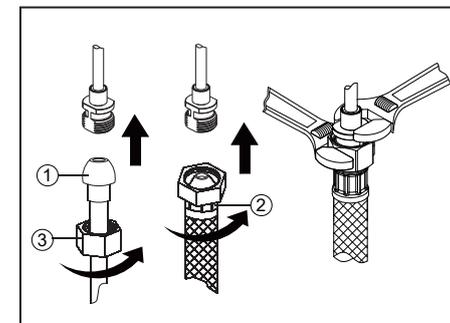
2. Conecta a las líneas de suministro. Usa conexiones de grifos de 1/2" I.P.S (2) o las tuercas de acoplamiento de líneas de suministro incluidas (3) con un tubos montantes de bola de diámetro exterior de 3/8" (1). Usa llaves para apretar las conexiones. No aprietes demasiado.
