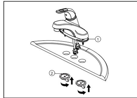
1. Cierre el suministro de agua antes de instalar. Quite la llave vieja. Coloque el empaque (1) in la parte inferior de la llave. Coloque la llave de agua a través de los agujeros de instalación en el fregadero. Fije la llave al fregadero con las contratuercas (2) proporcionadas. Retira la funda del tubo de entrada.
