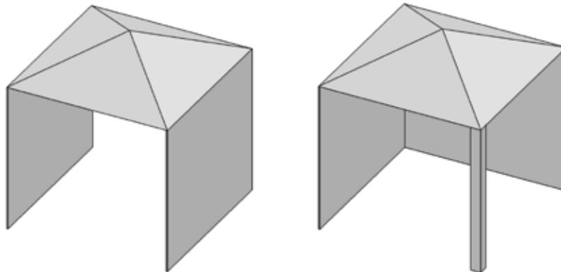
Installation à l'intérieur d'une enceinte partielle qui comprend un recouvrement sur le dessus et trois murs latéraux, dans la mesure où 30 pour cent ou plus de la périphérie horizontale de l'enceinte est ouverte en permanence.
