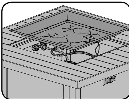
3. Débranchez le raccord flexible en acier inoxydable de l'injecteur à l'aide de deux (2) clés.
