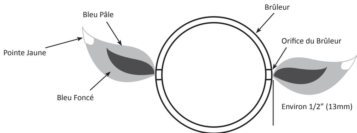
**Brûleur tubulaire** : Le brûleur est fait d'acier inoxydable 304, mais en raison de la chaleur extrême et d'un environnement corrosif, il se produira une corrosion de surface. Enlevez cette corrosion à l'aide d'une brosse en laiton. Nettoyez les orifices bouchés à l'aide d'un trombone déplié. N'agrandissez surtout pas les orifices du brûleur.
