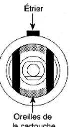
l'installation de la plomberie brute et de la garniture. Si l'étrier n'est pas installé correctement, la pression d'eau risque de propulser la cartouche hors de sa forme et ainsi causer des blessures et des dégâts d'eau sur les lieux de travail.
