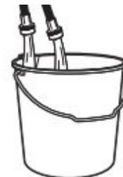
Faire couler l'eau par les tuyaux dans l'évier de buanderie, le tuyau de rejet à l'égout ou le seau pendant quelques secondes pour éviter toute obstruction. On doit laisser couler l'eau jusqu'à ce qu'elle soit limpide.
