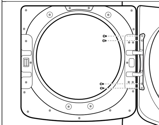
À l'aide d'un tournevis T25<sup>®</sup>, réinstaller les quatre vis fixant la charnière de la porte à la sécheuse.
