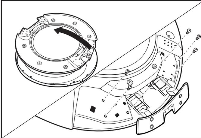
Inverser l'intérieur de porte vers la gauche. À l'aide d'un tournevis T20®, réinstaller la charnière sur le côté opposé (par rapport à celui d'où il a été enlevé).
