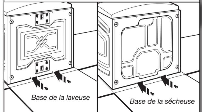
Insérer partiellement les deux vis de tôlerie à tête hexagonale n° 12 x 5/8" dans les trous inférieurs et laisser un espace d'environ 3/8" (10 mm) entre la tête de vis et le fond de la laveuse/sécheuse.
