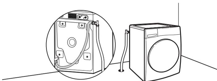
Le système de vidange au plancher nécessite un ensemble de brise-siphon, deux ensembles de raccordement et une rallonge de tuyau de vidange qui peuvent être achetés séparément. Contacter le revendeur pour effectuer la commande ou voir la page "Assistance ou service" au dos du guide d'utilisation et d'entretien. Hauteur minimale du brise-siphon : 28" (710 mm) à partir du fond de la laveuse. (Des tuyaux supplémentaires peuvent être requis).
