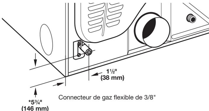
**\*REMARQUE :** Si la sècheuse est montée sur un piédestal, prévoir 10" (254 mm) ou 15,5" (394 mm) de plus à partir du sol pour la hauteur de la canalisation d'arrivée de gaz, en fonction du modèle de piédestal. Pour une installation dans un garage, prévoir 18" (460 mm) de plus à partir du sol pour la hauteur de la canalisation d'arrivée de gaz.
