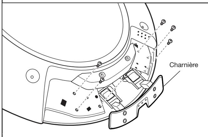
À l'aide d'un tournevis T20®, retirer les six vis maintenant en place la charnière.
