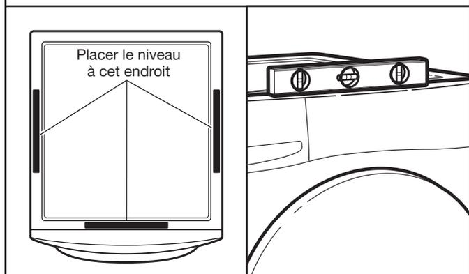
Enlever le morceau de carton placé sous la laveuse. Placer un niveau sur les bords supérieurs de la laveuse en contrôlant chaque côté et l'avant. Si elle n'est pas d'aplomb, faire basculer la laveuse et régler les pieds vers le haut ou vers le bas tel qu'indiqué dans les étapes 15 et 16, et recommencer si nécessaire.
