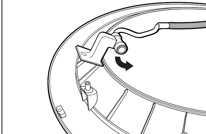
Replacer l'ensemble de rotation et le tube de 180°, du côté opposé de la porte.
