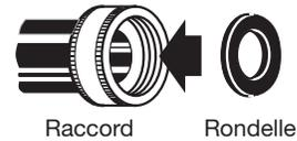
**IMPORTANT :** Afin d'éviter toute fuite, vérifier que les tuyaux d'arrivée d'eau comportent des rondelles d'étanchéité plates aux deux extrémités. La laveuse doit être raccordée aux robinets d'eau à l'aide des tuyaux d'arrivée d'eau et des rondelles neuves (non compris). Ne pas utiliser de tuyaux usagés. Ne pas utiliser de tuyaux sans installer de rondelles d'étanchéité.
