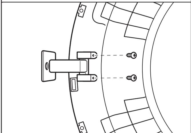
Soulever le panneau interne de porte. À l'aide d'un tournevis cruciforme, retirer les deux vis fixant l'ensemble de rotation à la porte.
