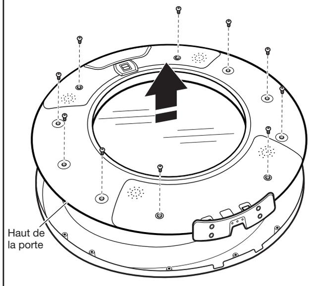
Positionner la porte de façon à ce que l'intérieur de la porte soit orienté vers le haut. À l'aide d'un tournevis cruciforme, retirer les 10 vis fixant l'intérieur de porte à l'extérieur de porte.
