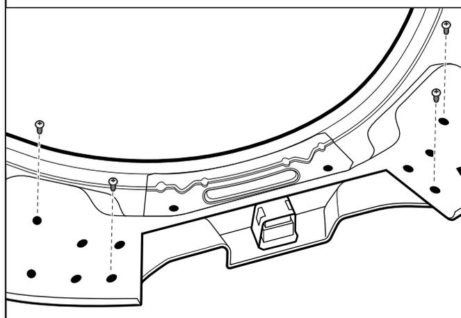
À l'aide d'un tournevis T25®, réinstaller la plaque du loquet sur le côté opposé (par rapport à celui d'où il a été enlevé) en utilisant les quatre vis enlevées précédemment.
