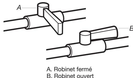
Ouvrir le robinet d'arrêt du conduit d'alimentation; le robinet est ouvert lorsque la poignée est parallèle au conduit. Puis vérifier tous les raccordements en les badigeonnant d'une solution de détection des fuites non corrosive approuvée. L'apparition de bulles indique la présence d'une fuite. Réparer toute fuite éventuelle.
