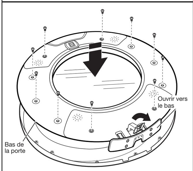
Positionner la porte de façon à ce que l'intérieur de la porte soit orienté vers le haut. À l'aide d'un tournevis cruciforme, réinstaller les 10 vis enlevées précédemment pour fixer l'intérieur de porte à l'extérieur de porte.
