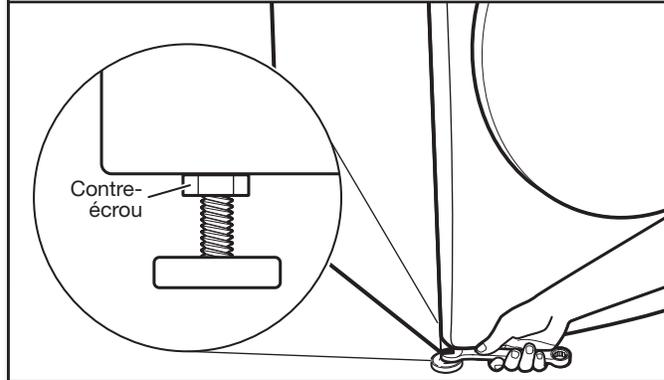
Une fois que la laveuse est d'aplomb et que les quatre pieds sont bien au contact du plancher, de la laveuse établi, utiliser une clé plate ou une clé à molette de 9/16" (14 mm) pour tourner les contre-écrous sur les pieds de nivellement dans le sens anti-horaire et les serrer fermement contre la caisse de la laveuse.
