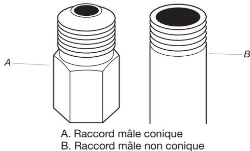
Retirer le capuchon rouge de la canalisation d'arrivée de gaz. À l'aide d'une clé pour serrer, raccorder l'alimentation en gaz à la sècheuse. Utiliser un composé d'étanchéité des tuyauteries sur tous les filetages des raccords mâles non coniques. Si on utilise un conduit métallique souple, veiller à ce qu'il ne soit pas pincé.
