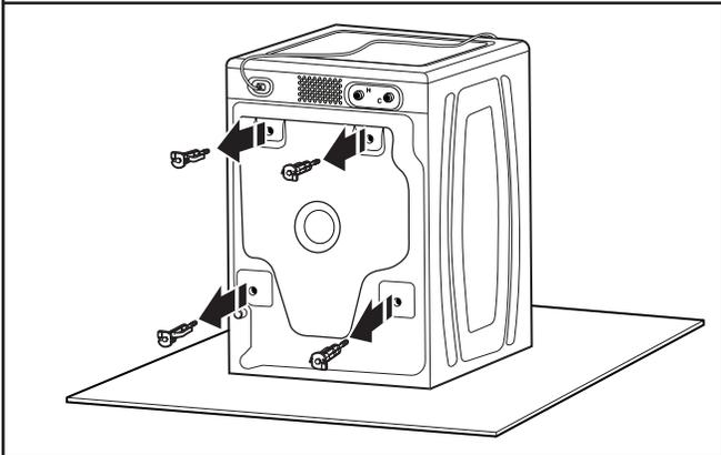
Desserrer les boulons avec une clé de 5/8" (16 mm). Déplacer chaque boulon et cale vers le centre du trou. Retirer les boulons et les cales en plastique de l'arrière de la laveuse. Jeter les boulons et cales d'espacement.
