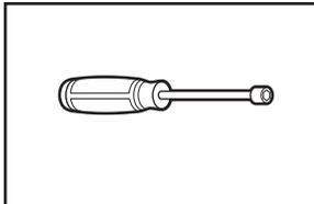
Tourne-écrou de 1/4" (6 mm) et 5/16" (8 mm) (recommandé)
