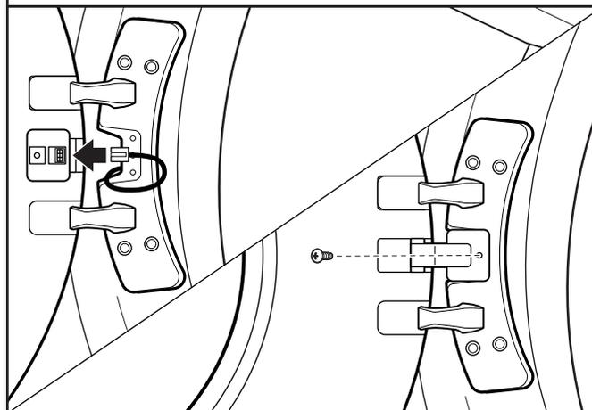
Brancher le câblage. À l'aide d'un tournevis cruciforme, fixer l'ensemble de rotation à la charnière en utilisant la vis enlevée précédemment.
