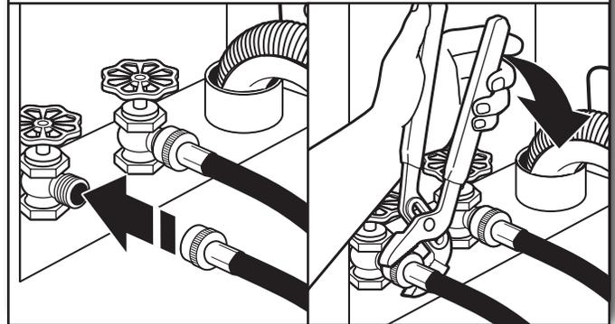
Fixer le tuyau dont l'étiquette porte la mention "hot" (chaud) au robinet d'eau chaude. Visser le raccord à la main pour qu'il repose sur la rondelle. Serrer les raccords de deux tiers de tour supplémentaires à l'aide d'une pince. Répéter cette étape avec le tuyau portant la mention "cold" (froide) pour le robinet d'eau froide. Les deux tuyaux doivent être raccordés pour que la laveuse fonctionne correctement.
