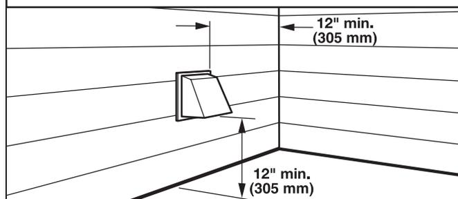
Installer le clapet d'évacuation et utiliser un composé de calfeutrage pour calfeutrer le côté extérieur de l'ouverture murale autour du clapet d'évacuation.
