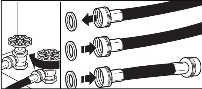
Arrêter le robinet d'eau froide et retirer le tuyau d'alimentation de la laveuse.
