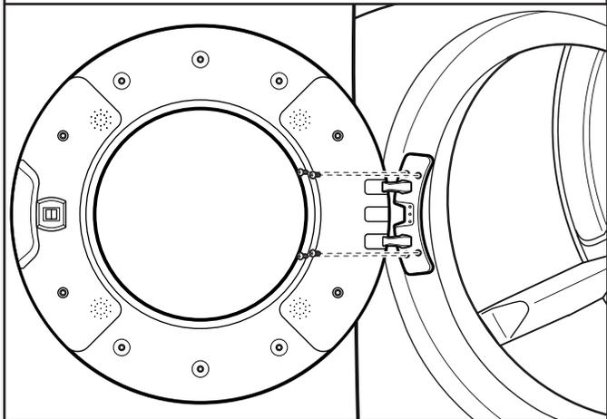
**Portes avec câblage électrique :** Passer le câblage par l'ouverture du panneau avant, avant de réinstaller la porte.
