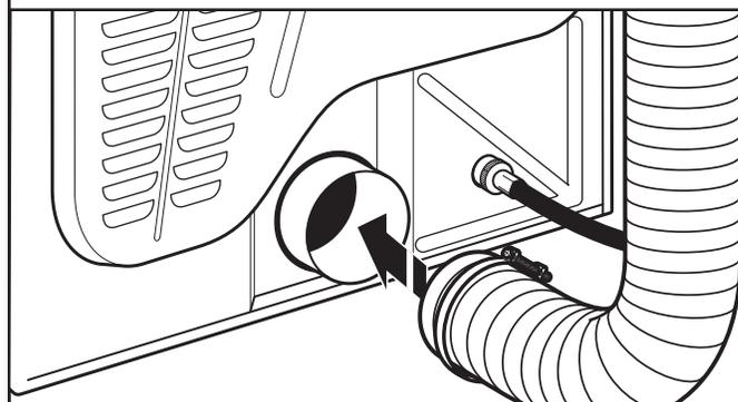
À l'aide d'une bride de serrage de 4" (102 mm), relier le conduit d'évacuation à la bouche d'évacuation de la sécheuse. Si on utilise le conduit d'évacuation existant, s'assurer qu'il est propre. Le conduit d'évacuation de la sécheuse doit être fixé par-dessus la bouche d'évacuation et à l'intérieur du clapet d'évacuation. Vérifier que le conduit d'évacuation est fixé au clapet d'évacuation à l'aide d'une bride de serrage de 4" (102 mm).
