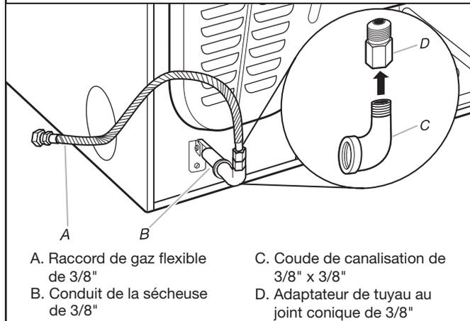
On doit utiliser une combinaison de raccords de canalisation pour raccorder la sècheuse à l'alimentation en gaz existante. Un raccordement est illustré. Le raccordement peut varier, selon le type d'alimentation, la dimension et l'emplacement.
