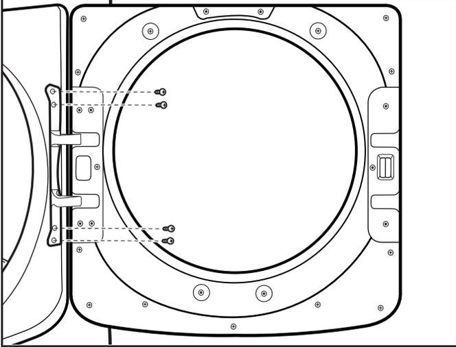
À l'aide d'un tournevis T25®, retirer les quatre vis fixant la charnière de porte à la sécheuse et soulever la porte pour la retirer. Placer la porte sur une serviette douce ou sur une surface lisse. Conserver ou mettre les quatre vis de côté.
