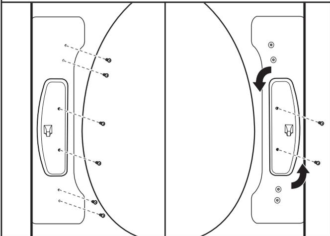
À l'aide d'un tournevis T25®, retirer les deux vis fixant la gâche de la porte au châssis de la porte de la sécheuse. Retirer les quatre vis au-dessus et en dessous de la gâche de la porte et les mettre de côté pour utilisation ultérieure. Faire pivoter la gâche de 180° et la fixer au côté opposé du châssis de la porte de la sécheuse, tel qu'indiqué.
