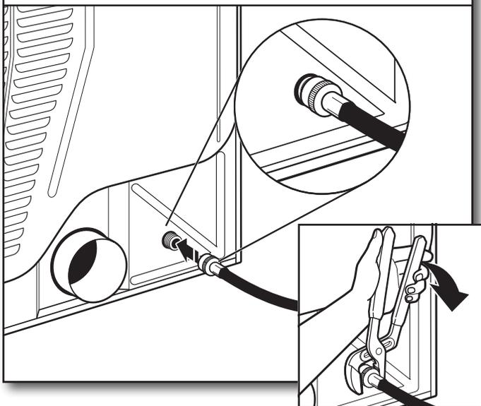
Ôter le capuchon protecteur de l'orifice d'arrivée d'eau. Fixer l'extrémité inclinée du long tuyau au robinet de remplissage au bas du panneau arrière de la sécheuse. Visser complètement le raccord à la main pour qu'il soit scellé au raccord du robinet de remplissage. Terminer le serrage des raccords – deux tiers de tour supplémentaires avec une pince.
