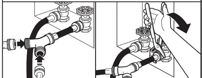
Fixer une des extrémités du tuyau d'arrivée d'eau de 5 pi (1,5 m) au connecteur en "Y". Fixer le tuyau d'alimentation en eau froide de la laveuse à l'autre extrémité du raccord en "Y". Visser le raccord à la main pour qu'il repose sur le connecteur. Terminer le serrage des raccords – deux tiers de tour supplémentaires avec une pince.
