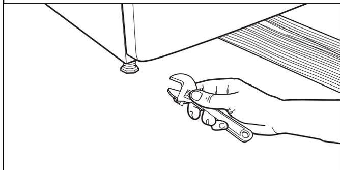
Si la sécheuse n'est pas d'aplomb, la relever à l'aide d'un bloc de bois, utiliser une clé pour ajuster les pieds vers le haut ou vers le bas, et vérifier à nouveau si elle est d'aplomb. Une fois la sécheuse d'aplomb, s'assurer que les quatre pieds sont en contact ferme avec le plancher et que la sécheuse ne tanguent pas.
