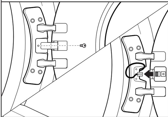
À l'aide d'un tournevis cruciforme, retirer la vis centrale de la charnière. Déconnecter le câblage. Passer le câblage dans l'ouverture.
