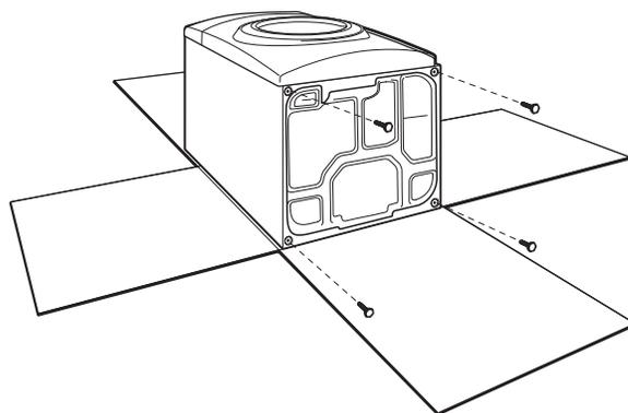
Pour ne pas endommager le plancher, utiliser une grande pièce de carton de l'emballage de la sècheuse; la placer sous tout le bord arrière de la sècheuse. Saisir fermement la sècheuse par la caisse (non par le panneau de commande) et incliner soigneusement la sècheuse sur le carton.
