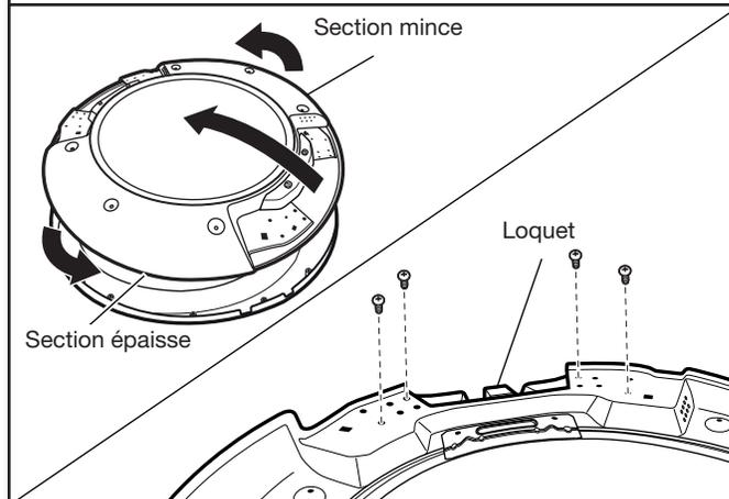
Inverser et faire pivoter l'intérieur de porte de 180° pour que la section mince se situe en haut et la section épaisse en bas. À l'aide d'un tournevis T25®, retirer les quatre vis maintenant en place la plaque du loquet.
