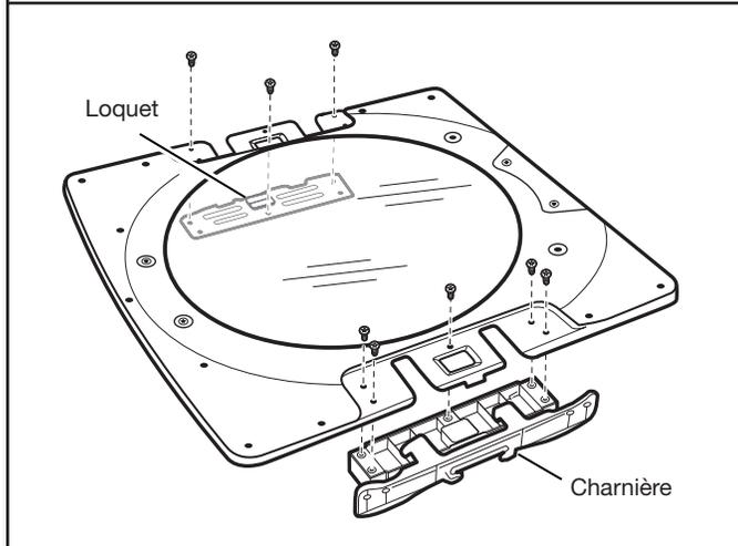
À l'aide d'un tournevis T25<sup>®</sup>, réinstaller la plaque de protection du loquet, la plaque de support du loquet et la charnière sur les côtés dont elles ont été respectivement retirées.
