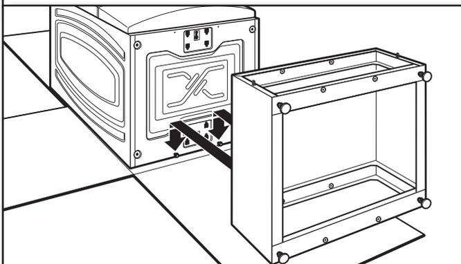
Placer le piédestal en contact avec la base de la laveuse/sécheuse. Engager les ouvertures en trou de serrure du piédestal sur les deux vis inférieures partiellement enfoncées.
