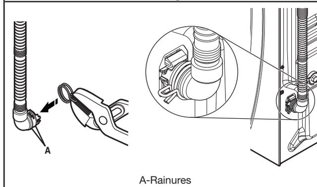
Si la bride n'est pas déjà installée sur l'extrémité coudée du tuyau de vidange, serrer la bride avec une pince et la faire glisser sur l'extrémité du tuyau en la centrant entre les rainures tel qu'illustré. Serrer la bride avec une pince et faire glisser à nouveau l'extrémité coudée du tuyau de vidange sur l'orifice de vidange, puis fixer avec la bride.
