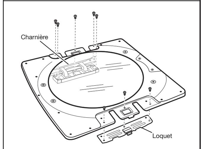
À l'aide d'un tournevis T25®, retirer les trois vis fixant la plaque de protection du loquet et la plaque de support du loquet; retirer aussi les cinq vis maintenant la charnière en place.
