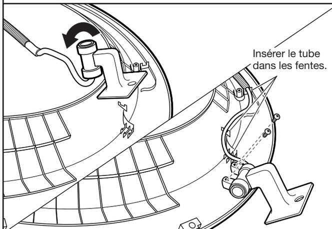
Faire tourner la base de l'ensemble de 180° vers vous et le fixer à l'aide des deux vis enlevées précédemment à l'aide d'un tournevis cruciforme. Insérer le tube dans les fentes.
