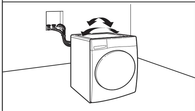
Saisir la laveuse par le dessus et la faire basculer d'avant en arrière tout en s'assurant que les quatre pieds sont en contact ferme avec le plancher. Faire de nouveau basculer la laveuse, transversalement. Si la laveuse bascule, passer à l'étape 15 et ajuster les pieds de nivellement. Si les quatre pieds sont en contact ferme avec le plancher, passer à l'étape 16.
