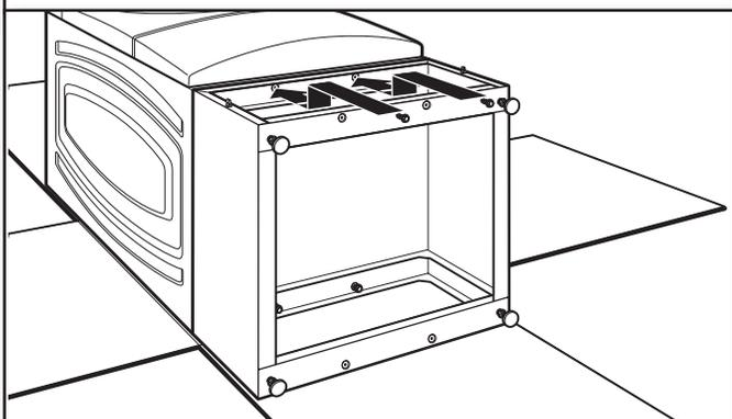
Positionner le piédestal vers l'avant de la laveuse/sécheuse et installer les deux autres vis de tôlerie à tête hexagonale. Ne pas visser complètement.
