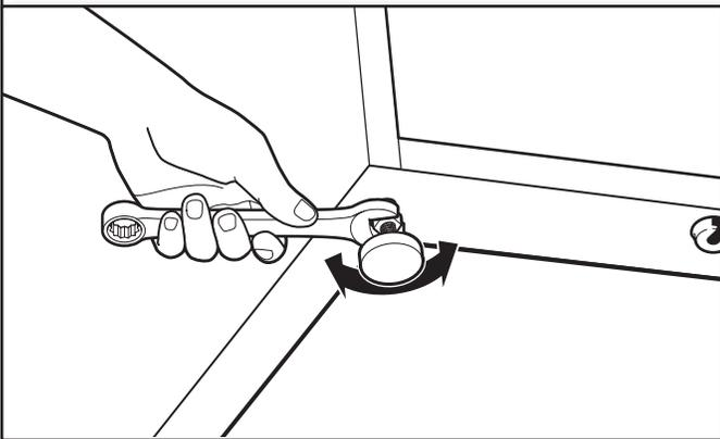
Une fois la laveuse ou la sécheuse d'aplomb et les quatre pieds sont bien en contact avec le plancher, utiliser une clé plate de 9/16" pour fixer solidement les quatre contre-écrous contre le piédestal.
