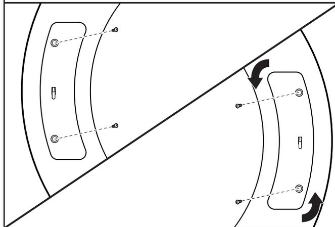
À l'aide d'un tournevis T25®, retirer les deux vis fixant la gâche de la porte au châssis de la porte de la sécheuse. Faire pivoter la gâche de 180° et la fixer au côté opposé du châssis de la porte de la sécheuse à l'aide des deux vis enlevées précédemment, comme indiqué.
