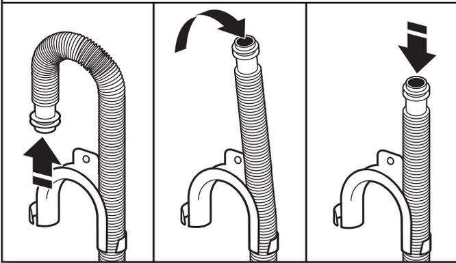
Pour les installations avec vidange au plancher, il faut retirer la bride de retenue pour tuyau de vidange de l'extrémité du tuyau de vidange. Des pièces supplémentaires avec des directives distinctes seront peut-être nécessaires. Voir "Autres pièces".
