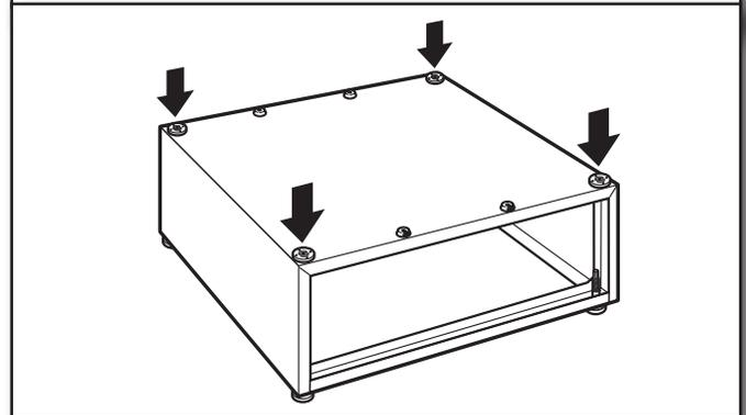
Veiller à placer les quatre cales d'espacement au sommet du piedestal. Les cales d'espacement réduisent les vibrations entre le piedestal et la laveuse/sécheuse.
