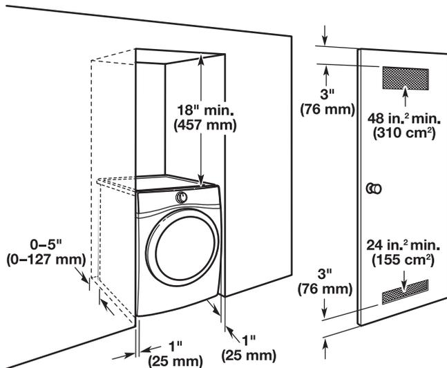
0" (0 mm) d'espace arrière est permis pour la ventilation droite seulement. Pour les modèles vapeur uniquement, le tuyau d'arrivée d'eau ne doit pas être torsadé.
