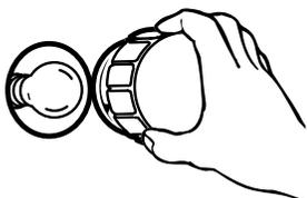
3. Tourner l'ampoule dans le sens antihoraire et l'enlever de la douille.
