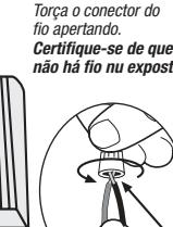
**AVERTISSEMENT :** Danger d'électrocution. Peut causer le décès de la personne ou de graves blessures. Couper le courant (off) au disjoncteur avant de procéder à l'installation.
