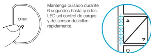
Mantenga pulsado durante 6 segundos hasta que los LED del control de cargas y del sensor destellen rápidamente.
