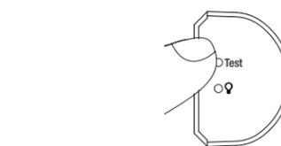
2 Avec le détecteur monté temporairement à l'emplacement prévu, parcourez l'espace en observant la lentille. Si la lentille brille, un mouvement est détecté.
