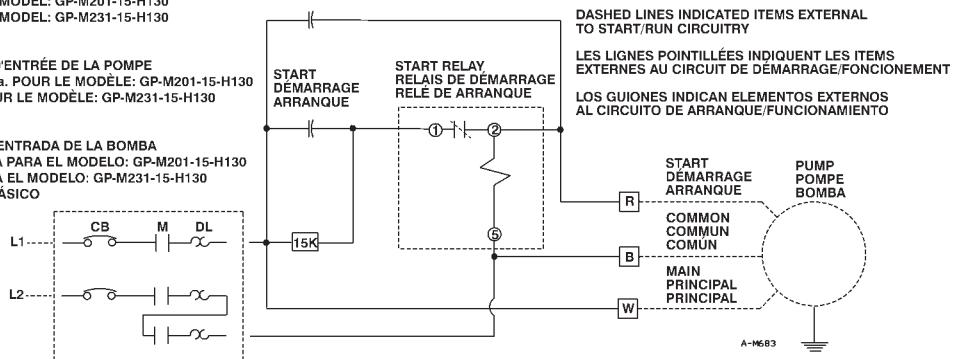
**PUMP START/RUN CIRCUITRY DIAGRAM**
