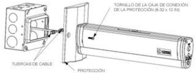
CONFIGURACIÓN 2: MONTAJE LATERAL SIN BARRA TRANSVERSAL (SI LOS ORIFICIOS DE LA CAJA DE CONEXIÓN SÍ SE ALINEAN CON LOS ORIFICIOS DE LA PROTECCIÓN)
