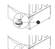
7 Gire las 4 patas de nivelación 1 en una dirección para elevar el pedestal o en la
