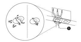
For conduit installations, insert the conduit strain relief in the 1 1/8 in. (2.8 cm) conduit hole. Then
