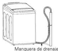
Manguera de drenaje
