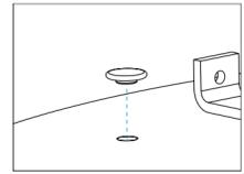
Pour le modèle Circular 3, recouvrez les trous non utilisés avec les charges fournies.
