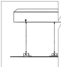
Utilisez les cordes fournies pour suspendre la plaque de couverture à la verrière pendant l'installation.
