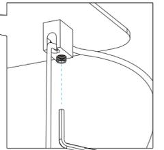
**2** Faites passer le câble dans le support de câble et serrez-le avec la clé hexagonale fournie. Chaque paire de fils doit être de longueur égale.
