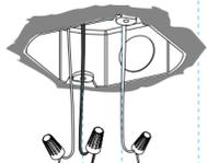
Faites passer les cordons d'alimentation CA des pilotes LED dans la boîte de jonction par le trou, puis connectez-les aux fils CA de la boîte de jonction. Fixez la verrière à la boîte de jonction. En option, à l'aide des vis fournies, fixez la verrière au plafond environnant. Assurez-vous que la verrière est centrée et recouvre entièrement la boîte de jonction.
