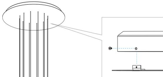
Une fois le câblage terminé, retirez les cordes de suspension et fixez la plaque de couverture en ajustant les deux vis sur les côtés.
