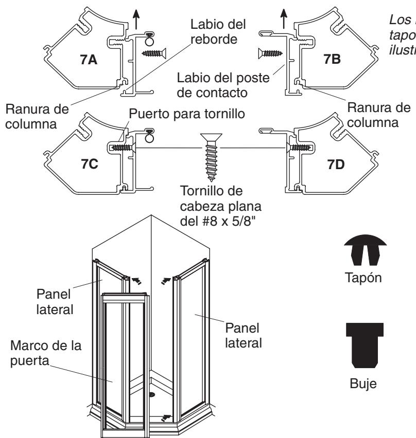
*Los bujes se colocan en el lado pivotante, los tapones en el lado de apertura de la puerta. Se ilustra con el lado pivotante hacia la izquierda.*
