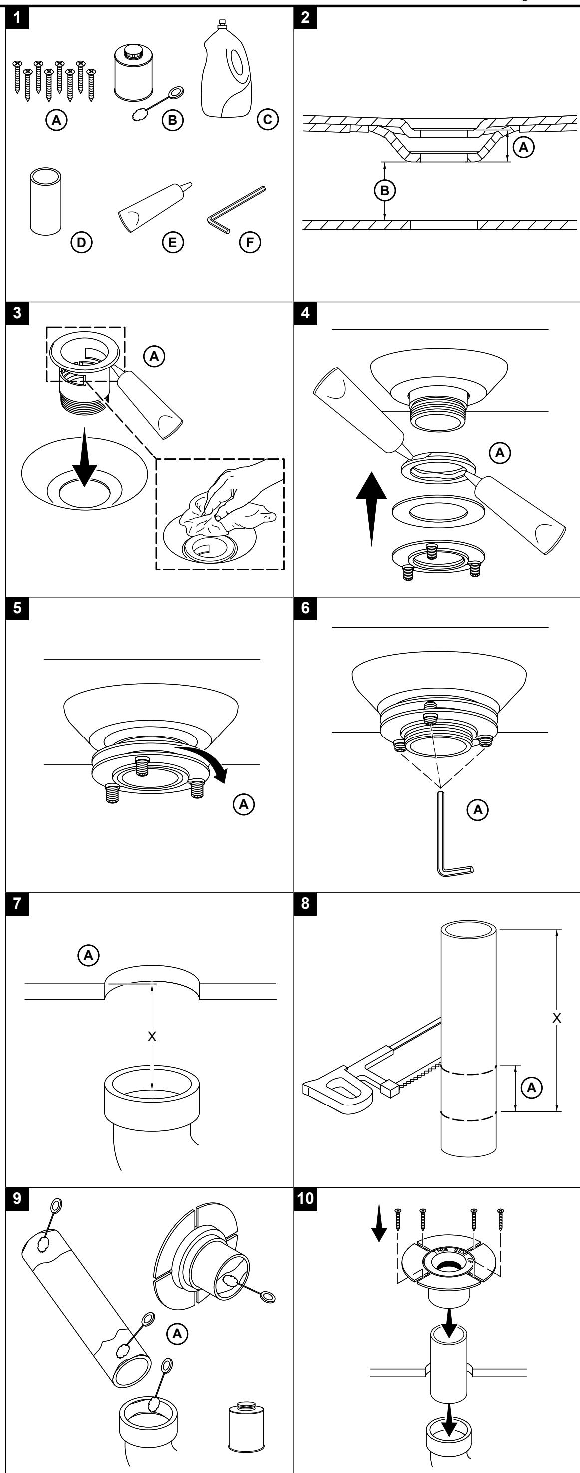
9A. Appliquer de l'apprêt et du ciment pour PVC sur les extrémités extérieures du tuyau en PVC, sur l'intérieur de la colerette, et sur l'intérieur du siphon en P.
