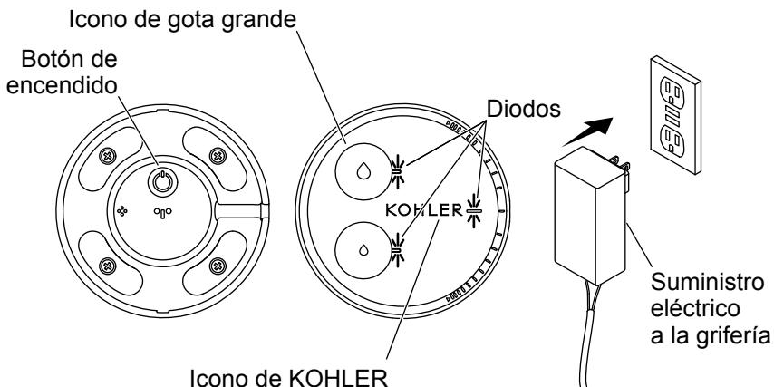
**NOTA:** Conecte el cargador si va a vincular un nuevo control remoto.
