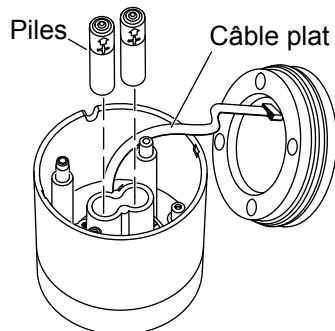
**REMARQUE :** Si la télécommande ne se charge plus ou si elle doit être rechargée trop souvent, les piles peuvent être remplacées.
