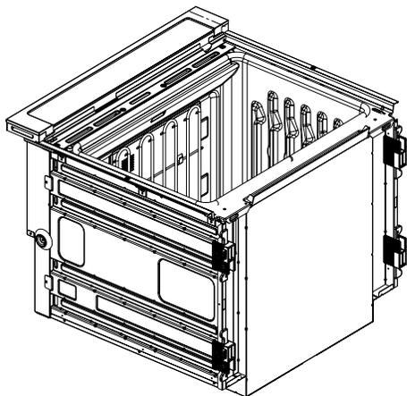
2. Retirer le pied de la cale d'espaceur avant droite en ôtant la vis n° 8-18 x  $\frac{3}{8}$ ".
