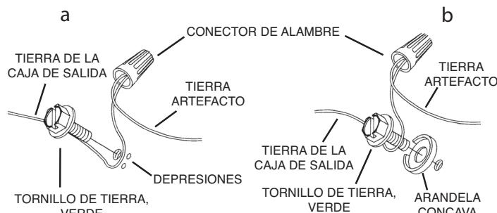
4. Haga las conexiones de los alambres. La tabla de referencia de abajo indica las conexiones correctas y los alambres correspondientes.
