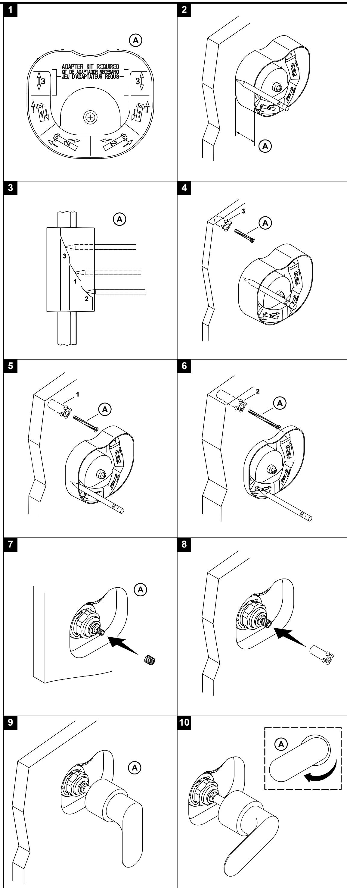
**4A. Pared delgada:** Use el adaptador #3 y el tornillo de 1-3/8" (35 mm).
